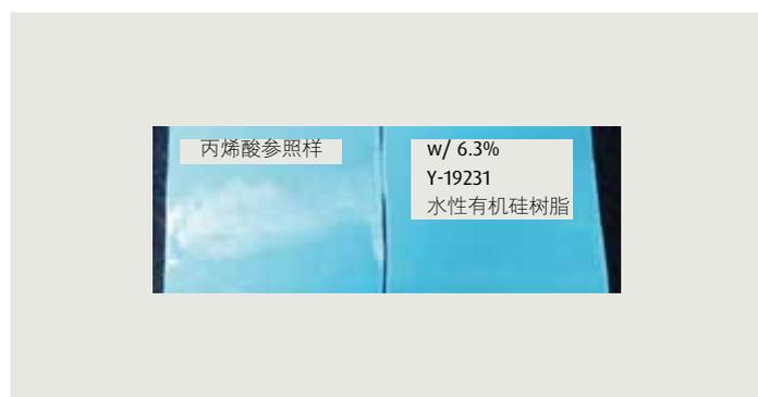
图3 添加有机硅树脂乳液与不添加有机硅乳液的耐沾污性对比
