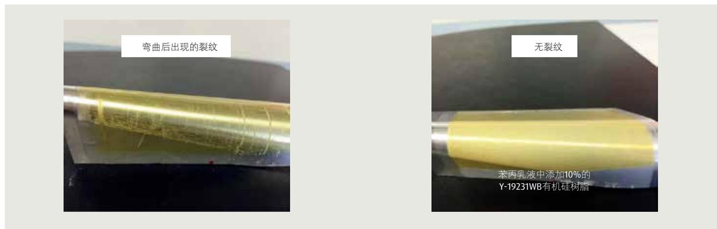
图2 通过添加有机硅树脂乳液提高耐渗碱性
